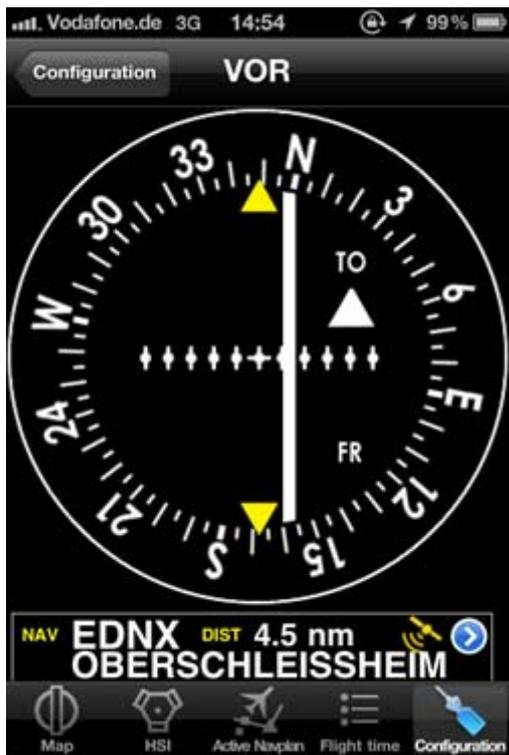
Comme l'ADF, l'instrument VOR est à utiliser à des fins de formation seulement et il utilise les données GPS pour afficher le relèvement à un waypoint.
