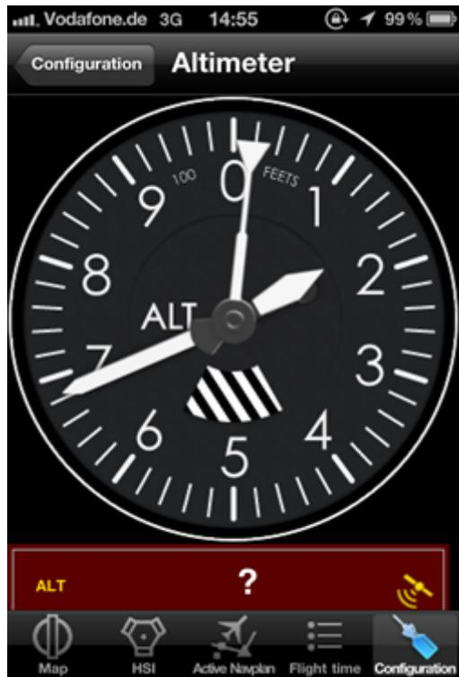
*La Pression atmosphérique est calculée sur les informations GPS, comme tous les instruments de navigation. Avec le kit de voiture (tom-tom) et avec le GPS Bluetooth externe, l'altimètre a une précision acceptable. Néanmoins, il ne doit jamais être utilisé comme en remplacement de l'altimètre de bord.*
