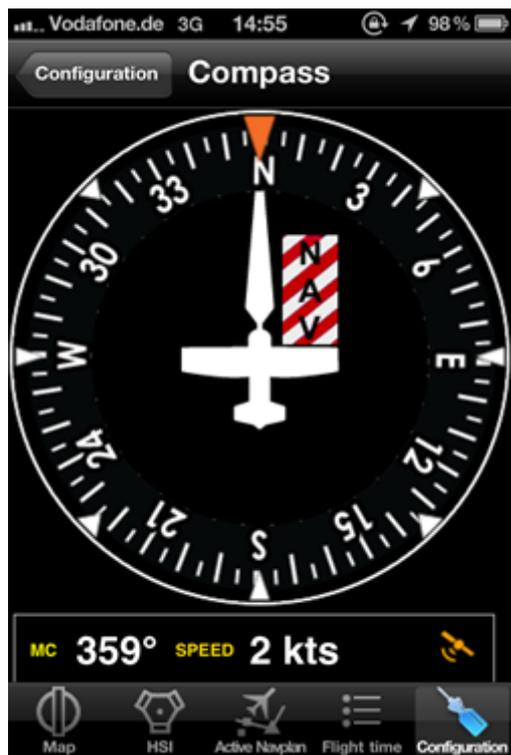
L'information de la «Boussole» montre le cap GPS. En raison de la grande erreur de la boussole intégrée de l'iPhone dans l'environnement du poste de pilotage, nous avons décidé de s'en tenir à des données GPS pour toutes les informations sur les caps.
