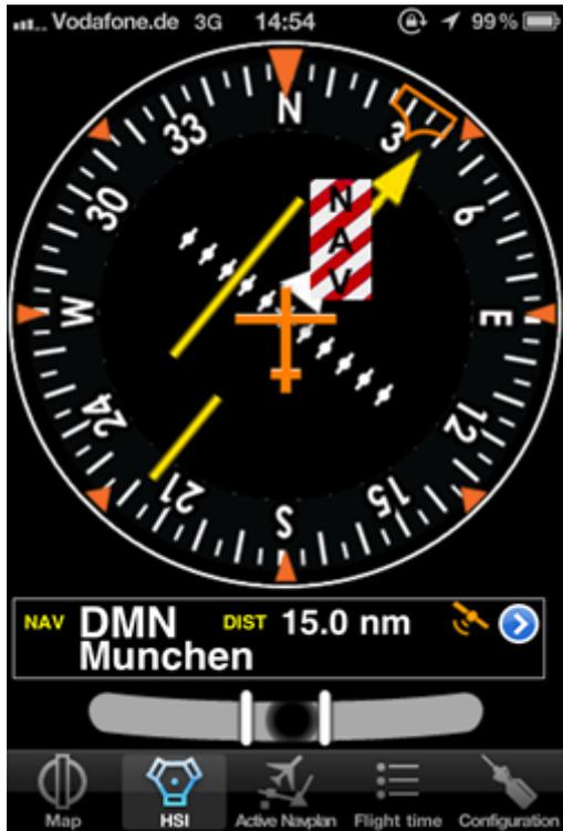
La partie supérieure de l'écran est un émulation du HSI, c'est le plus pratique des instruments de navigation traditionnels, mais il exige aussi une certaine formation pour être utilisé efficacement. Si la réception GPS est limitée, le drapeau d'avertissement **NAV** indique que l'instrument n'affiche pas les données correctes
