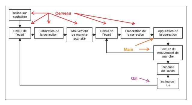
Que fait un pilote automatique ? Il fait exactement la même chose que nous mais avec des capteurs, des calculateurs et des actionneurs électroniques, mécaniques ou hydrauliques.
