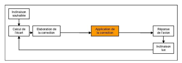
Mais ce n'est pas tout, il faut transmettre physiquement la correction à l'avion. Pour cela, le pilote utilisera le manche et déterminera la quantité et la vitesse de déplacement du manche à appliquer pour atteindre son objectif. Là encore il faudra peut être quelques cycles pour atteindre la position désirée. On se retrouve donc avec une nouvelle boucle d'asservissement (c'est le nom officiel de ce type de boucle) :
