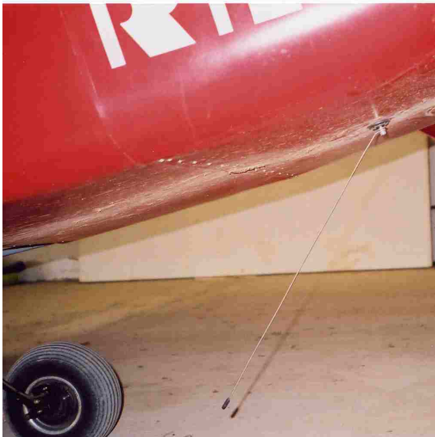
Monopôle placée sous la partie métallique de la cellule d'un multiaxe
